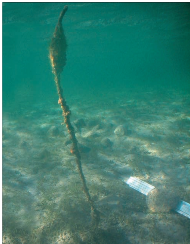
Abb. 16: Schwimmschnur zur Kennzeichnung eines Erosionsmarkerpflocks. Der Pflock selbst ist durch Sediment verschüttet. Foto: RPS/LAD, M. Mainberger.
