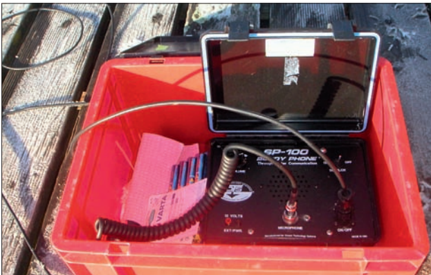
Abb. 6: Sprechfunkeinrichtung für Unterwasserkommunikation. Mit dem Gerät können Taucher untereinander sowie mit der Aufsicht oder dem Vermesser kommunizieren. Foto: RPS/LAD, M. Mainberger.
