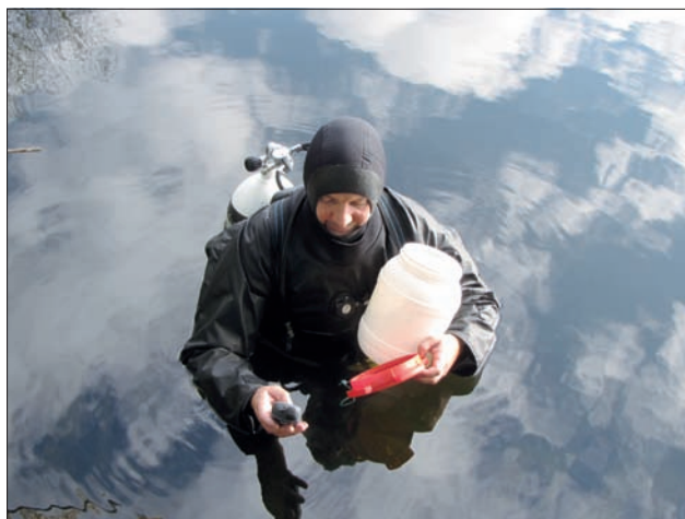
Abb. 8: Taucher mit Transportbehälter für Hand-GPS. Die Geräte erhalten unter dem Wasserspiegel keine Signale und müssen als Boje an der Wasseroberfläche mitgeführt werden. Foto: RPS/LAD, M. Heine.
