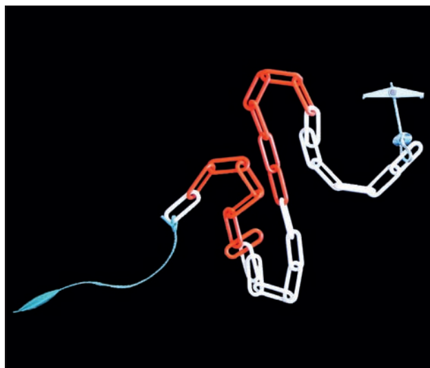
Abb. 19: Erosionsmarker aus Kunststoffkette. Am unteren Ende ist ein Klappdübel befestigt, am oberen Ende eine Schwimmschnur. Foto: RPS/LAD, S. Mainberger.
