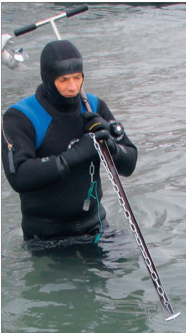
Abb. 20: In den Marschlöffel eingelegte Kette. Foto: RPS/LAD, J. MacIntosh.
