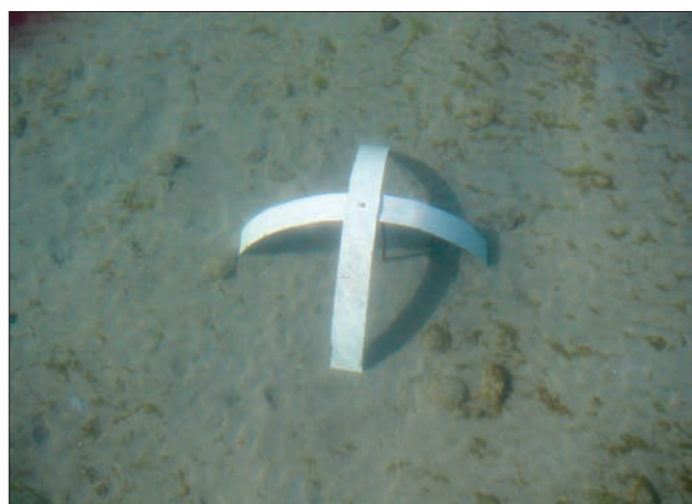
Abb. 14: Luftbildkreuz in der Station Litzelstetten-Krähenhorn. Das Kreuz ist für den Transport zusammenklappbar, mit Signalfarbe lackiert und besitzt Schenkellängen aus Edelstahl von 1 m. Foto: RPS/LAD, M. Mainberger.
