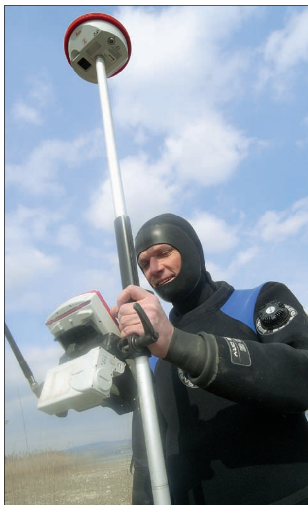
Abb. 10: RTK-GPS im Einsatz in Litzelstetten-Krähenhorn. Foto: RPS/LAD, M. Mainberger.
