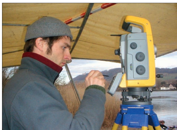
Abb. 4: Lasertachymeter beim Einsatz am Orkopf (Eschenz TG / Öhningen BW). Foto: RPS/LAD, M. Mainberger.
