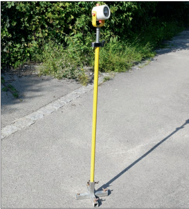
Abb. 5: Reflektor mit »Fuß«. Hier ist der »Knoten« eines stählernen Messrahmens verwendet. Entsprechende Einrichtungen sind im Handel als Zubehör erhältlich. Foto: RPS/LAD, M. Mainberger.
