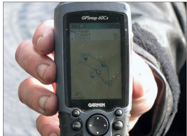
Abb. 7: Hand-GPS. Das Gerät ist wasserdicht und schwimmt auf. Auf dem Bildschirm ist ein vom Taucher geschwommener Kurs zu erkennen. Foto: RPS/LAD, M. Heine.
